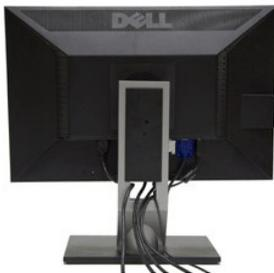
Setelah memasang semua kabel yang diperlukan ke monitor dan komputer, (Lihat [Menyambungkan Monitor](#) untuk pemasangan kabel,) gunakan slot manajemen kabel untuk mengatur semua kabel seperti ditunjukkan di bawah ini.
